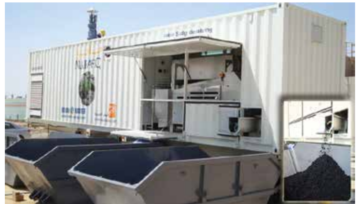
Marafiq - Système de déshydratation des boues - Jubail, KSA
