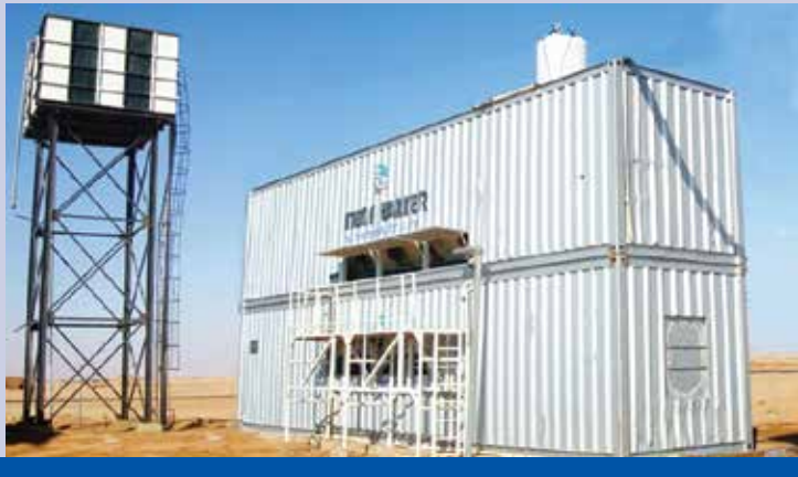
Marafiq dehidracija blata - 4 mobilne kontejnerske naprave 4x 8 m 3 /h, Jubail industrijska cona 1, Kraljevina Saudova Arabija
