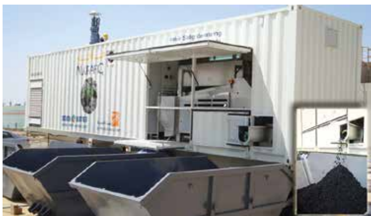
Marafiq - odwadnianie osadów - 4 mobilne urządzenia kontenerowe, 4 x 8 m 3 /dzień, Jubail Industrial Zone 1, Arabia Saudyjska
